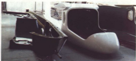
Detalle de los moldes y un fuselaje recién salido del "horno".
