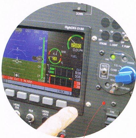
Perusvarustuksen instrumentointi on sekä lennon- että moottorinvalvonnan kattava Dynon 180 Flight Deck. Sininen nappi on potkurin lapakulmien valintakytkin.
