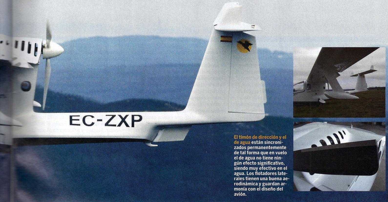
**El timón de dirección y el de agua** están sincronizados permanentemente de tal forma que en vuelo el de agua no tiene ningún efecto significativo, siendo muy efectivo en el agua. Los flotadores laterales tienen una buena aerodinámica y guardan armonía con el diseño del avión.
