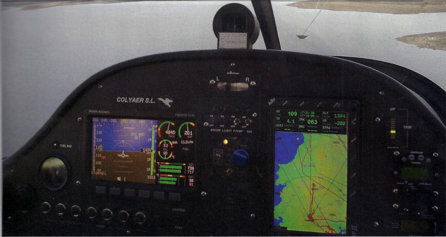
de los cuidados de la hierba, la lluvia hace mella y el tren lo nota. Comprobamos magnetos y temperatura, acelerero a fondo... en la carrera de despegue es donde más se nota la velocidad constante, En take Off está regulada a 5700 rpm. y mientras mantengo una leve presión en la palanca, el Colyaer levanta el morro al llegar a unos 70 km/h. A 80 km/h empieza a subir indicando el variómetro un ascenso a razón de 5 m/s, tren adentro - luces
